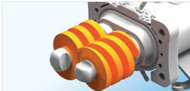
Эффективные, компактные насосы с двумя несоприкасающимися подающими винтами. Разработаны для сред низкой и средней вязкости, летучих или газообразующих сред. Конструкция насоса не содержит „мертвых“ и застойных зон. Высокая скорость работы двухвинтовых насосов позволяет использовать их в качестве технологических и очистных насосов.
